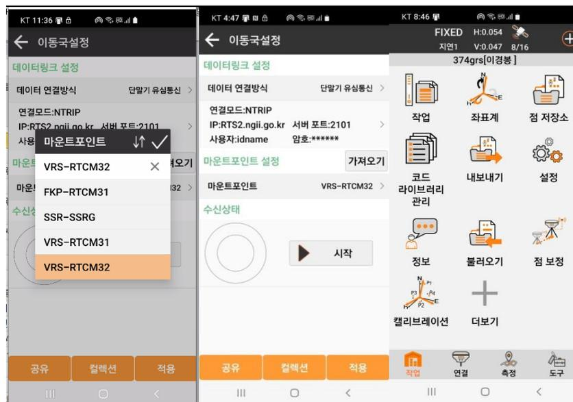
접속이 되면 화면 상단에 수평(H),수직(V)오차와 GPS접속 상태(Fixed,Float)가 나타나게 됩니다.
